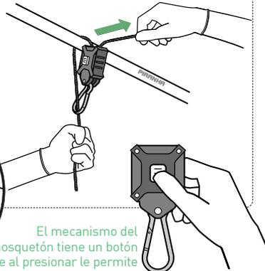
El mecanismo del mosquetón tiene un botón que al presionar le permite ajustar hacia abajo.
